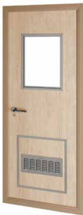
Дверь класса В-15 с остеклением, вентиляционной решёткой и аварийной филенкой
